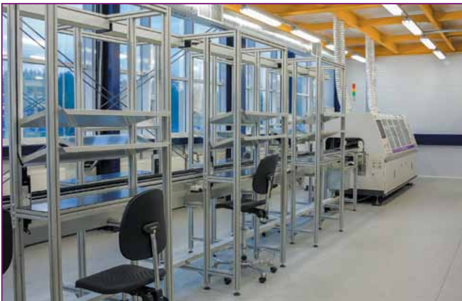
Сборочный конвейер и установка для пайки волной компании «Крафтвей»
