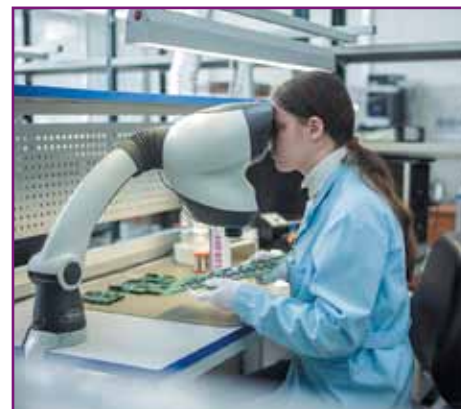
Участок контроля собранных печатных плат на производстве «Компас-Электроникс»
